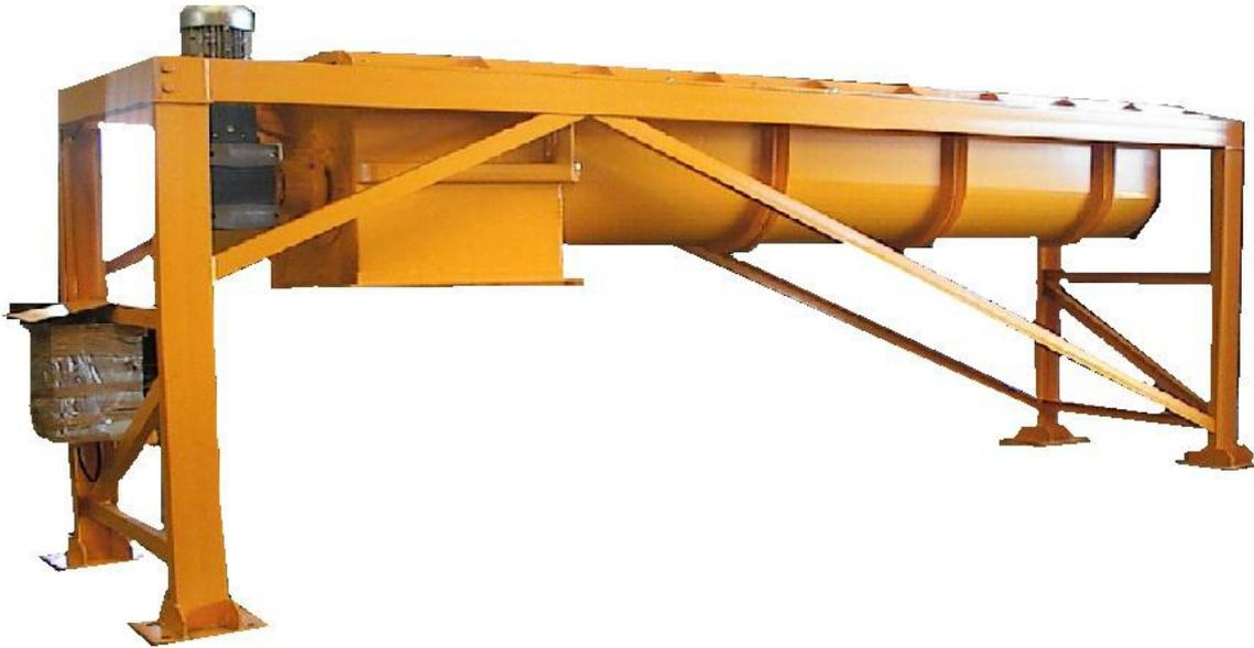
Homogeneizador de estructura metálica y gran consistencia en todas sus partes, preparado para recibir el material por medio de cintas transportadoras a través del tolván de alimentación , montado en la parte superior de la máquina en el extremo opuesto a la boca de salida del material. Construido en chapa de acero y ensamblado con soldadura de hilo continuo. Por su robusta construcción no es necesario un continuo mantenimiento.
