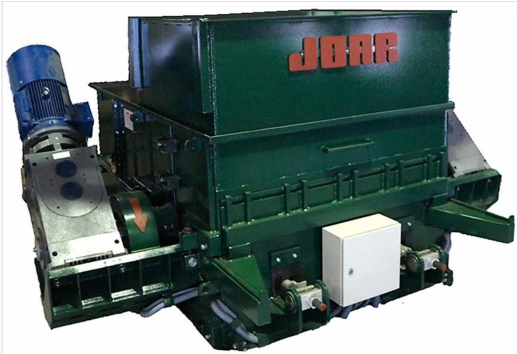
Es una máquina de gran consistencia y alta capacidad de producción adecuada para grandes y continuas cargas especialmente diseñada y construida para desgarrar las bolsas en las plantas de tratamiento de R.S.U. y multiproducto.
