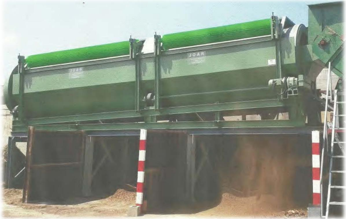
Es una máquina de gran consistencia y alta calidad de producción, especialmente diseñada y construida para el reciclado y afinado de residuos de poda y todo tipo de maderas. Es accionada mediante MOTORREDUCTORES de engranajes helicoidales con transmisión directa a ejes mediante enlace elástico.
