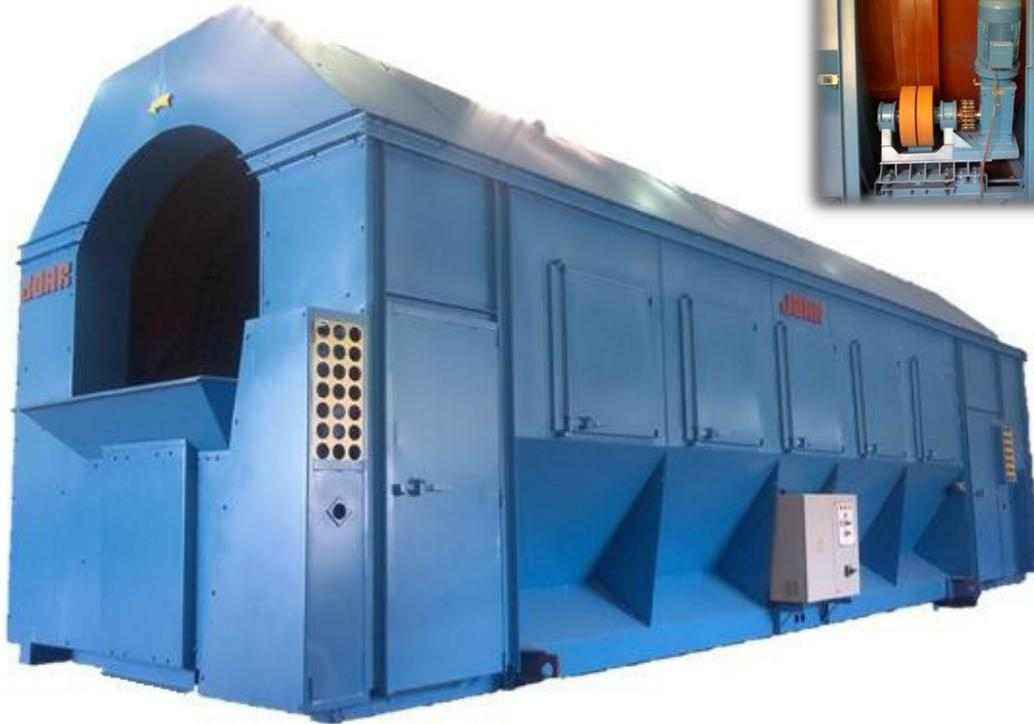
Es una máquina de gran consistencia y alta capacidad de producción, especialmente diseñada y construida para el reciclado y tratamiento de residuos de cualquier característica. Es accionada mediante MOTOR-REDUCTORES de engranajes helicoidales con transmisión directa a ejes mediante enlace elástico.
